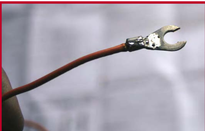
Kleine Öse, großer Wirkung. Kabel für die Batterie
